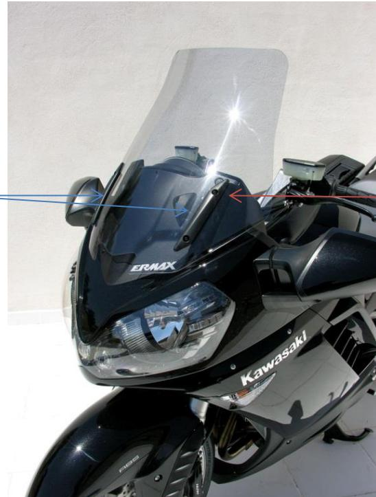
Caches, languettes en plastique et pattes de fixation de la bulle
