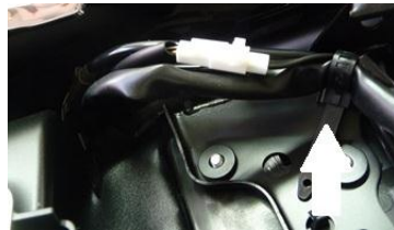
Clips et emplacement des cosses
