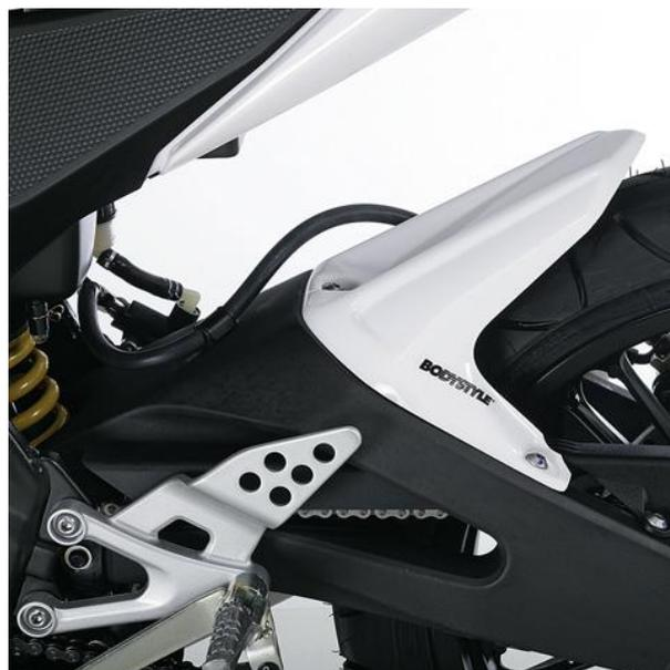
1. Demontieren Sie die originale Hinterradabdeckung und montieren Sie die Bodystyle Hinterradabdeckung an den Originalaufnahmen mittels den original Befestigungsschrauben.
