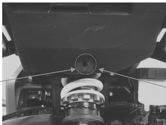
Position du collier de maintien des câbles électriques
