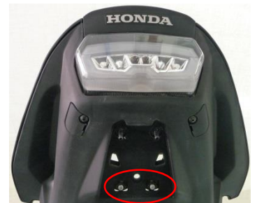
Vis de fixation du passage de roue
