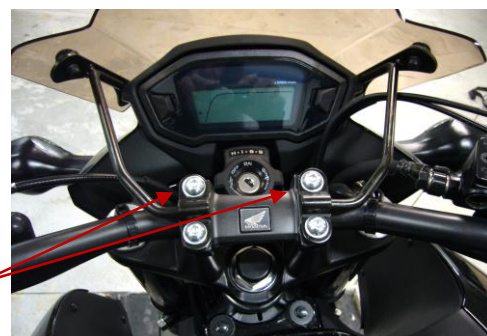
Photo 2 Vis à démonter et à remplacer
