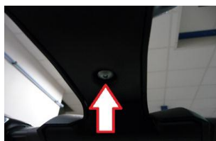
Vis cruciforme de la bavette
